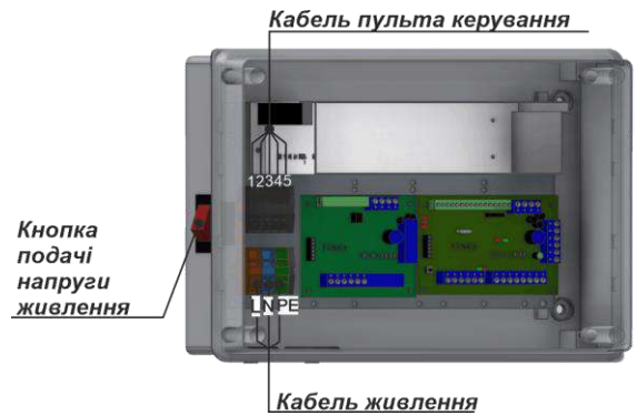
Рис.16 - Блок електронного керування – підключення турнікету
